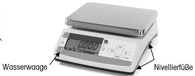
Abbildung 2-1. Nivellieren der Waage.
