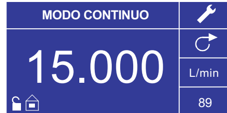
Figura 3-3. Operación en modo continuo
