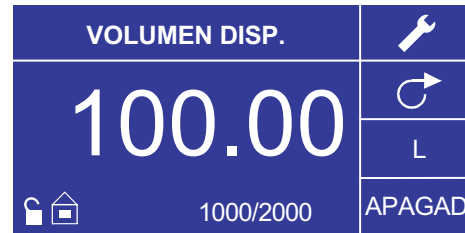
Figura 3-11. Operación en modo de descarga de volumen
