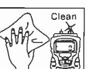
Siempre mantenga las clavijas de medición limpias y vuelva a colocar el recubrimiento protector cuando no las use.
