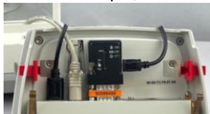
Adaptador Bluetooth e conexão de energia USB no EX
