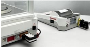
Adaptador BT y conexión USB trasera en AX Conexión del adaptador Bluetooth en la impresora
