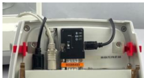
Collegamento dell'adattatore a Bluetooth e dell'alimentazione USB sull'EX
