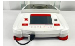
Conexão USB frontal no AX
