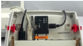
Bluetooth-Adapter- und USB-Stromanschluss am EX
