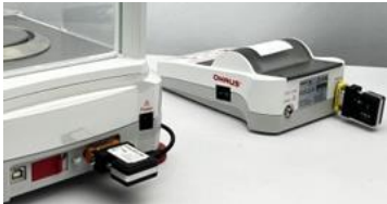
Adaptateur BT et connexion USB au dos de l'AX Connexion de l'adaptateur Bluetooth sur l'imprimante
