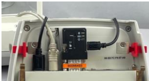
Adaptador Bluetooth y conexión de alimentación USB en EX
