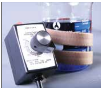
El control de porcentaje de tiempo regula cuánto tiempo está encendido el calentador y cuánto tiempo está apagado.
